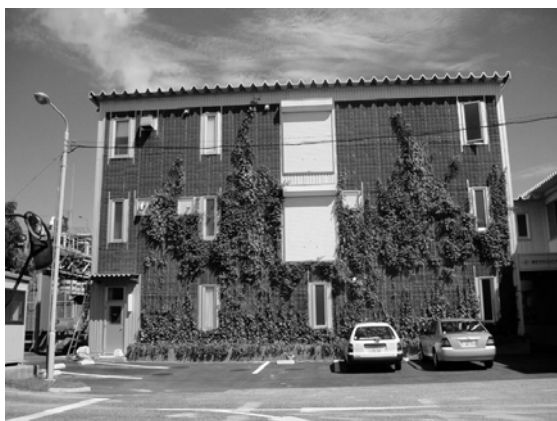
写真-1 豊田ケミカルエンジニアリング(株) 研究棟正面 (西向き, 外壁:ガルバリウム鋼板) 試験開始時の壁面緑化状況と鋼板面へのセンサ設置箇所 : 鋼板露出部 : 壁面緑化パネル裏鋼板面 つる植物なし : 壁面緑化パネル裏鋼板面 つる植物被覆部 気温は底の直下にて測定した
