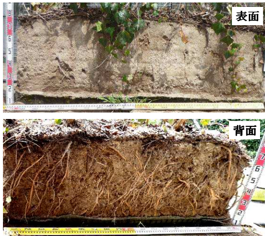
写真-4 試験区IIIの表面と背面の地下部状況
