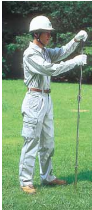
落錘を落とし採土部を土壌に買入
