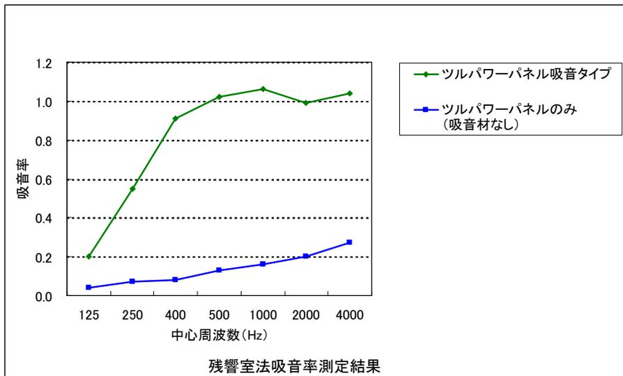
測定は、JIS A 1409「残響室法吸音率の測定方法」に準拠
