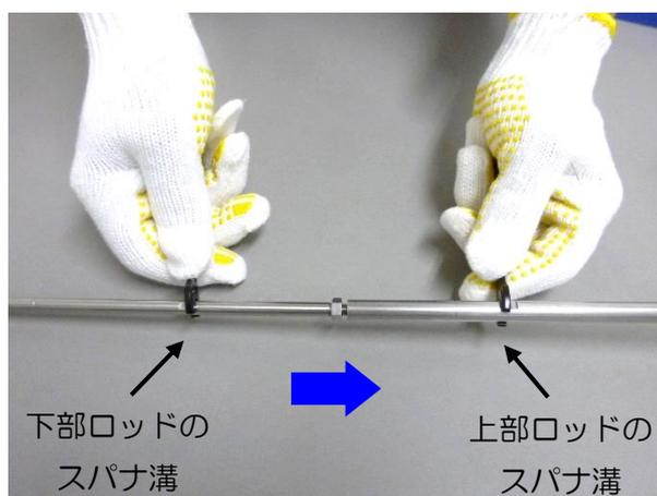
※ロッドの雄ネジを雌ネジの奥まで挿し込まずに使用すると、ネジが折れてしまう可能性があります。ロッドが回らなくなるまで挿し込んでからナットを締めて下さい。
